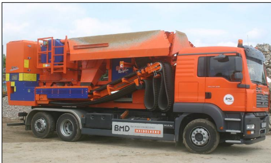
Figura 114 – Usina móvel de RCC.
